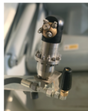
△ Ramiona z głowicami myjącymi ▽ oraz dyszami „Turbo”
